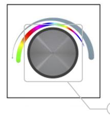
Botón de encendido y apagado y rueda de regulación y cambio de color. Para cambiar de modo regulación a cambio de color se debe pulsar dos veces de
